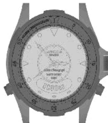
Résultat obtenu après importation du calque du cadran dans AutoCAD, activation de la transparence et placement du cadran sur le rendu
